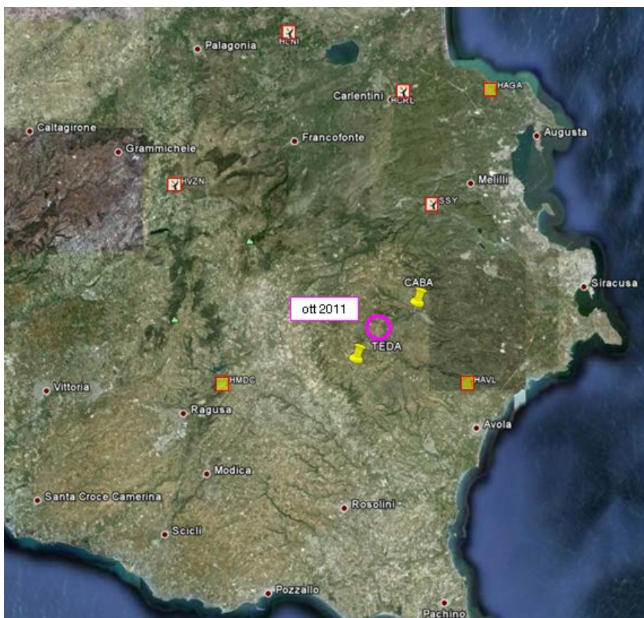
Fig. 23 - Localizzazione della Rete Sismica permanente gestita dall'INGV - Sezione di Catania; i quadrati rossi indicano stazioni digitali 3 C a larga banda; i segnaposti TEDA e CABA mostrano i siti delle stazioni sismiche mobili (3 C a larga banda) installate il 10/10/2011.
